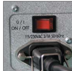
Anti-traction sur le câble d'alimentation
