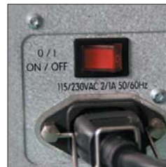
Anti-traction sur le câble d'alimentation
